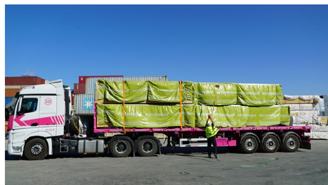
חבילות עץ קשירת לוחות עץ, באמצעות רצועות של 2 טון לפחות (צבע ירוק), כל חבילה בנפרד, בשתי נקודות. יש להצמיד את חבילות העץ לדופן הקדמית. יש לוודא התקנת קרש הגבהה לכל חבילה, לצרכי פריקה וטעינה.
